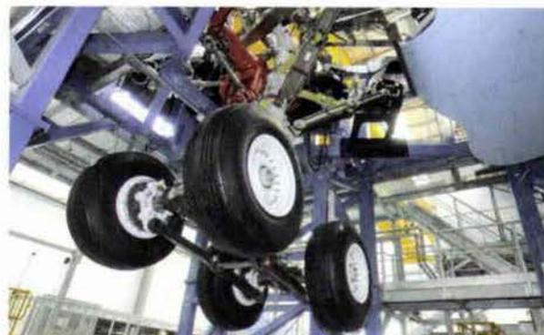
Avant d'arriver à Toulouse, les tronçons et les équipements sont testés dans les autres usines du groupe. Les tests du train d'atterrissage principal ont été réalisés au Royaume-Uni un an avant le premier vol.
