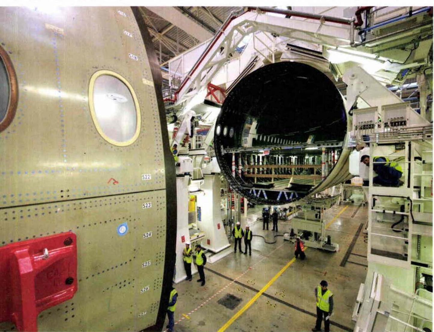
Les sections sont jointes le plus tôt possible pour disposer d'un fuselage complet. Les tronçons en matériaux composites sont ajustés grâce à un système de positionnement laser.
