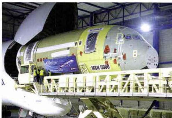
Les différents tronçons de l'appareil arrivent des autres usines du groupe par avion-cargo Beluga. Un atout pour réduire le cycle d'assemblage de l'appareil.
