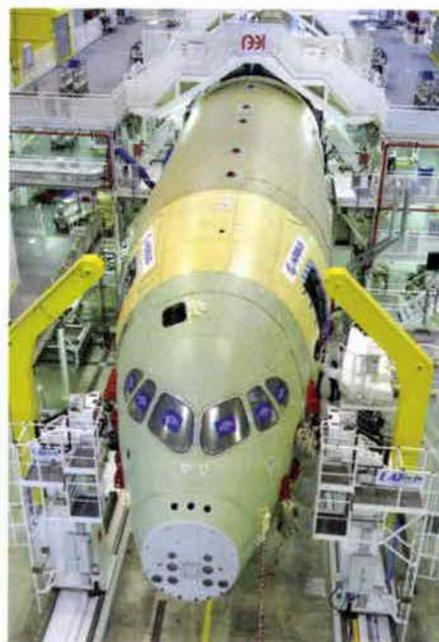
Pour s'adapter aux différentes dimensions de chacune des versions de l'appareil, les outillages sont mobiles.
