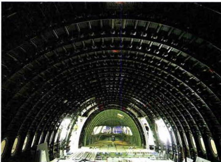
Avec l'A 350, les tronçons permettant de constituer la cabine sont associés en amont. Pendant qu'une équipe aménage l'intérieur, une autre procède au raccordement des ailes. De quoi réduire de 30% le temps d'assemblage.
